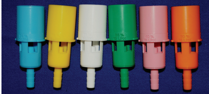
Figura 1.8. Adaptadores de \text{FiO}_2 distintos, da marca Hudson®. Pipeta Azul 24% a 3 L/min, pipeta amarela 28% a 6 L/min, pipeta branca 31% a 8 L/min, pipeta verde 35% a 12 L/min, pipeta rosa 40% a 15 L/min e pipeta laranja 50% a 15 L/min.
