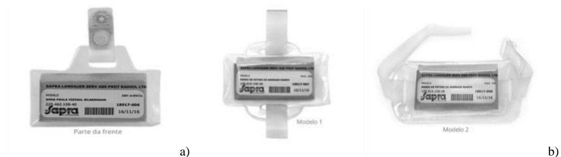
Figura 5: Monitor pessoal (dosímetro OSL), a) tórax b) pulseira. Fonte: Sapra Landauer
