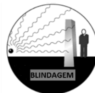
Figura 3: Regras gerais de proteção radiológica, blindagem.
