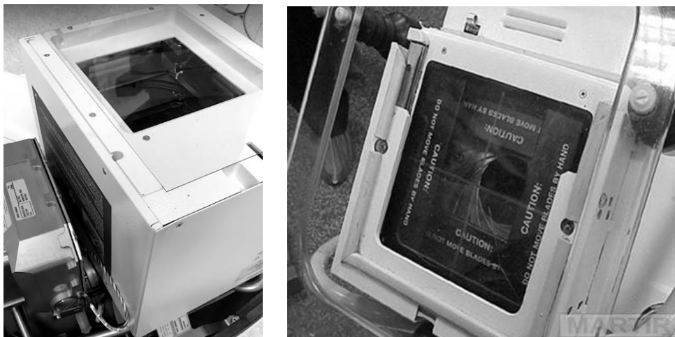
Figura 4: Imagem dos sistemas colimadores de angiógrafos. Fonte: O Autor (esquerda); RPOP IAEA (direita)
