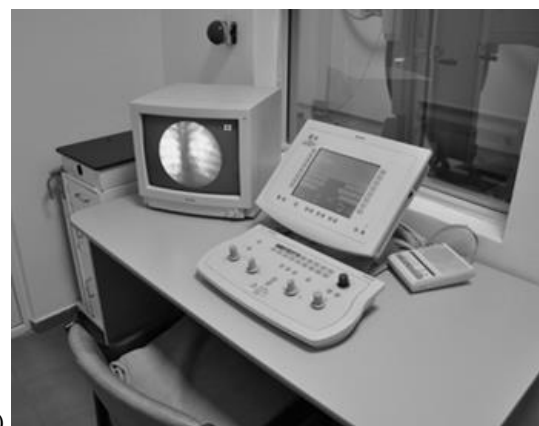
Figura 8: a) Equipamento de fluoroscopia com tubo de raios x sobre a mesa b) Comando para operação remota (telecomandado). Fonte: Philips Healthcare
