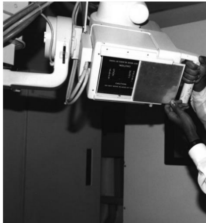
Figura 16: Filtro adicional. Fonte: Dimenstein e Ghilardi
