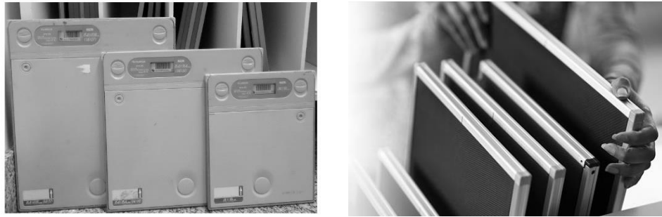
Figura 14: Chassis contendo IP's em três tamanhos distintos. Percebe-se que há uma região com código de barras onde as imagens são identificadas e podem ser associados aos dados do paciente.
