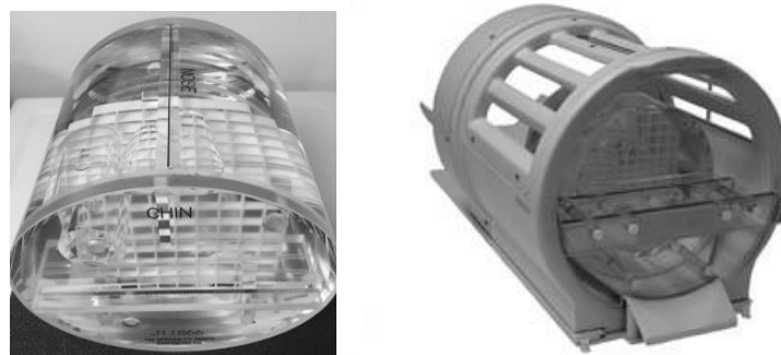
Figura 12: Exemplo de um fantoma utilizado para controle de qualidade em RM. Fonte: ACR
