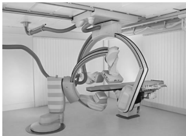
Figura 10: Equipamento de fluoroscopia com dois arcos-C (biplanos). Fonte: Siemens Healthineers
