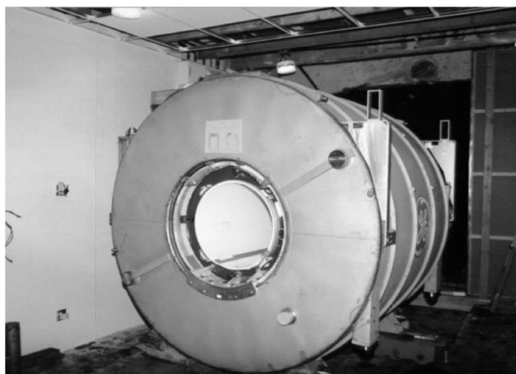
Figura 35: Magneto supercondutor de 1,5T. Fonte: Mazzola
